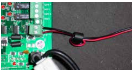
Ferrithülse auf dem Stromversorgungskabel
